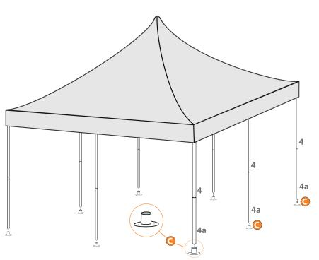
Sichern Sie nun sofort das Gestänge mit den Stangenerdhaken. Achten Sie hierbei darauf, dass die Stangen senkrecht und in einer Flucht stehen.
