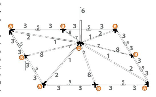
Befestigen Sie zunächst mit den Schrauben M8 die mitgelieferten Tellerfüße (C) an die Standrohre (4a). Stecken Sie nun, durch Anheben des Zeltes die Standfußstangen (4+4a) ein. Sie benötigen je Standfußstange eine Person zum Anheben und Einstecken.
